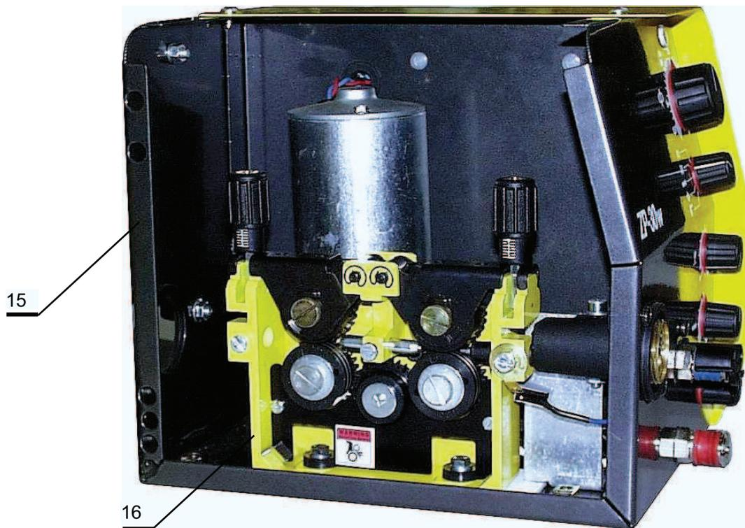
Rys. 3. Zespół podający ZP-30w. Widok kasety po otwarciu osłony zespołu napędowego.
